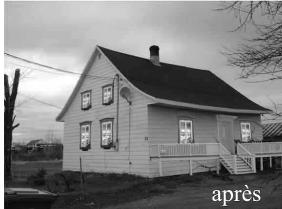
a) Rétablissement de l'équilibre de la fenestration sur le mur de côté et de façade avec ajout de fenêtres à 6 carreaux et encadrements autour des ouvertures. Ajout d'un décor de porte et d'une galerie faisant toute la façade et munie d'une balustrade de type traditionnel.
