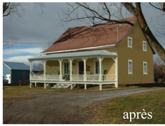
c) Rétablissement de l'équilibre de la fenestration en façade et sur le mur de côté avec ajout d'encadrements autour des ouvertures. Remplacement du porche avant par une galerie couverte faisant toute la façade avec balustrade traditionnelle et des aiselliers. Pose d'un nouveau recouvrement en bois.
